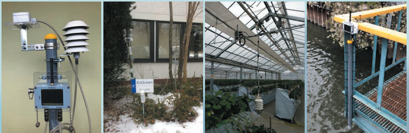
センサー側送信機接続例 (温度 & 湿度センサー, 照度センサー)
