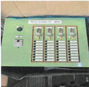
40Aのコントローラー ヒーター線16本取り付け可能 温調器付き
