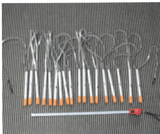
長さ 全長約6m(ラインヒーター実長11m) スポット本数 17 電圧 48V / 電力 約50W / 温度 約40℃/1本
