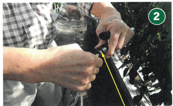
ラインヒーターを折り曲げアルミパイプのヘッドキャップゴムスリット部へ差し込む
